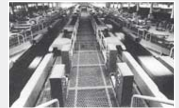
省力荷役の決め手としてターミナルに設置された自動仕分け機
